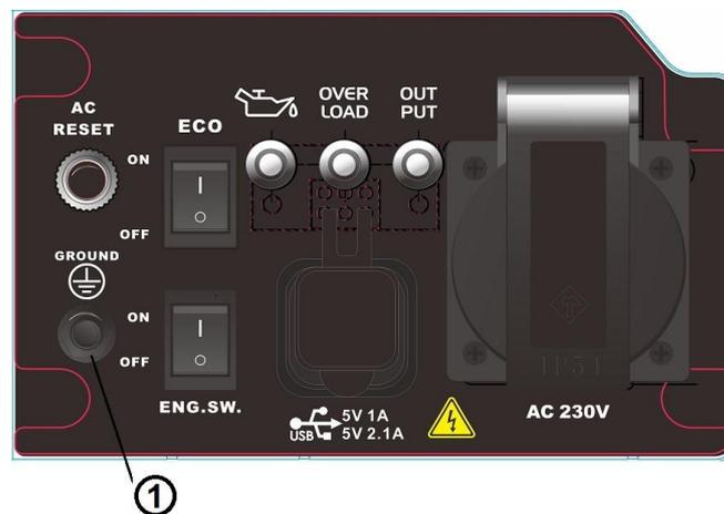
El terminal de tierra ① conecta la línea de tierra para prevenir descargas eléctricas. Cuando el dispositivo eléctrico está conectado a tierra, siempre el generador debe estar conectado a tierra.
